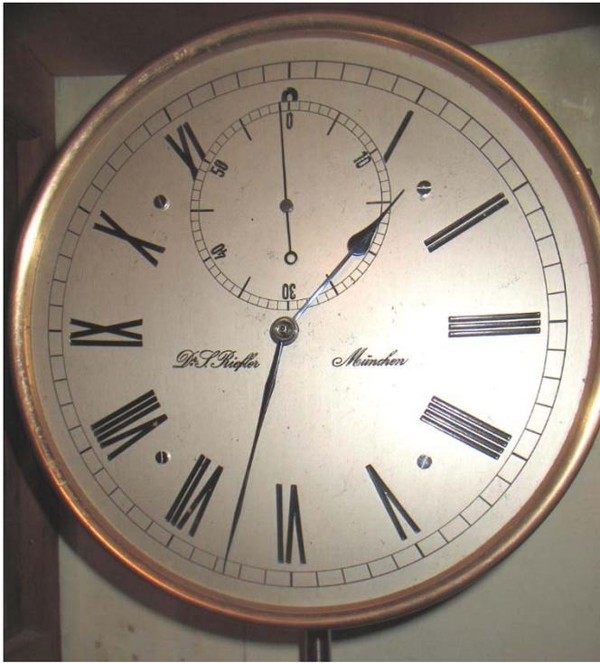
Abb. xxx: Das konzentrische schlichte Zifferblatt der Riefler-Uhr No. 32 von etwa 1898 mit Winbauer-Werk und Winbauers Antrieb über elektrisch betätigten Schwerkrafthebel. Man beachte die Signatur mit „Dr. S. Riefler München“. So war ihm beim Betrachten seiner Laboratoriumsuhre immer seine frisch verliehene Doktorwürde bewusst. Foto: Dieter Riefler
